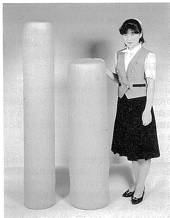
図22 スプレーフォーミング法で製造された急冷凝固合金プリーフォーム外観
