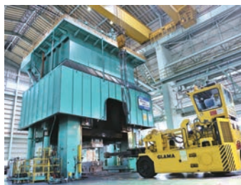
15,000 t大型鍛造プレス機
