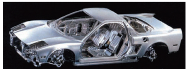
Fig. 8 Monocoque structure vehicle (NSX/HONDA).
