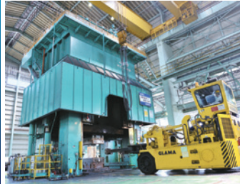
15,000 t大型鍛造プレス機
