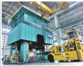
15,000 t大型鍛造プレス機
