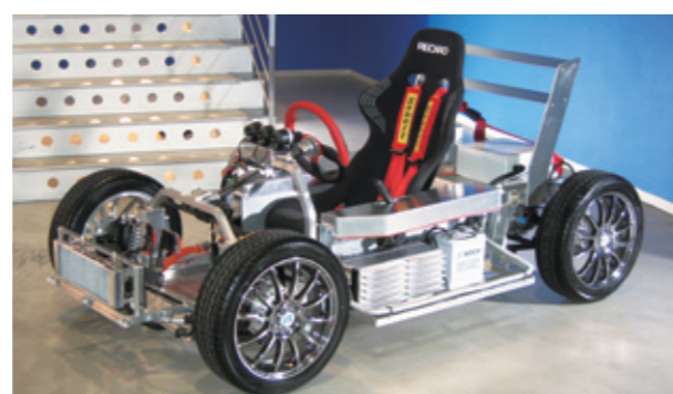
電気自動車 EVA-01-RS (エバワン) 電池ユニットカバー、遮音材、高熱伝導ヒートシンク、制振材、摩擦撾拌接合(FSW)車体フレームなどを搭載
